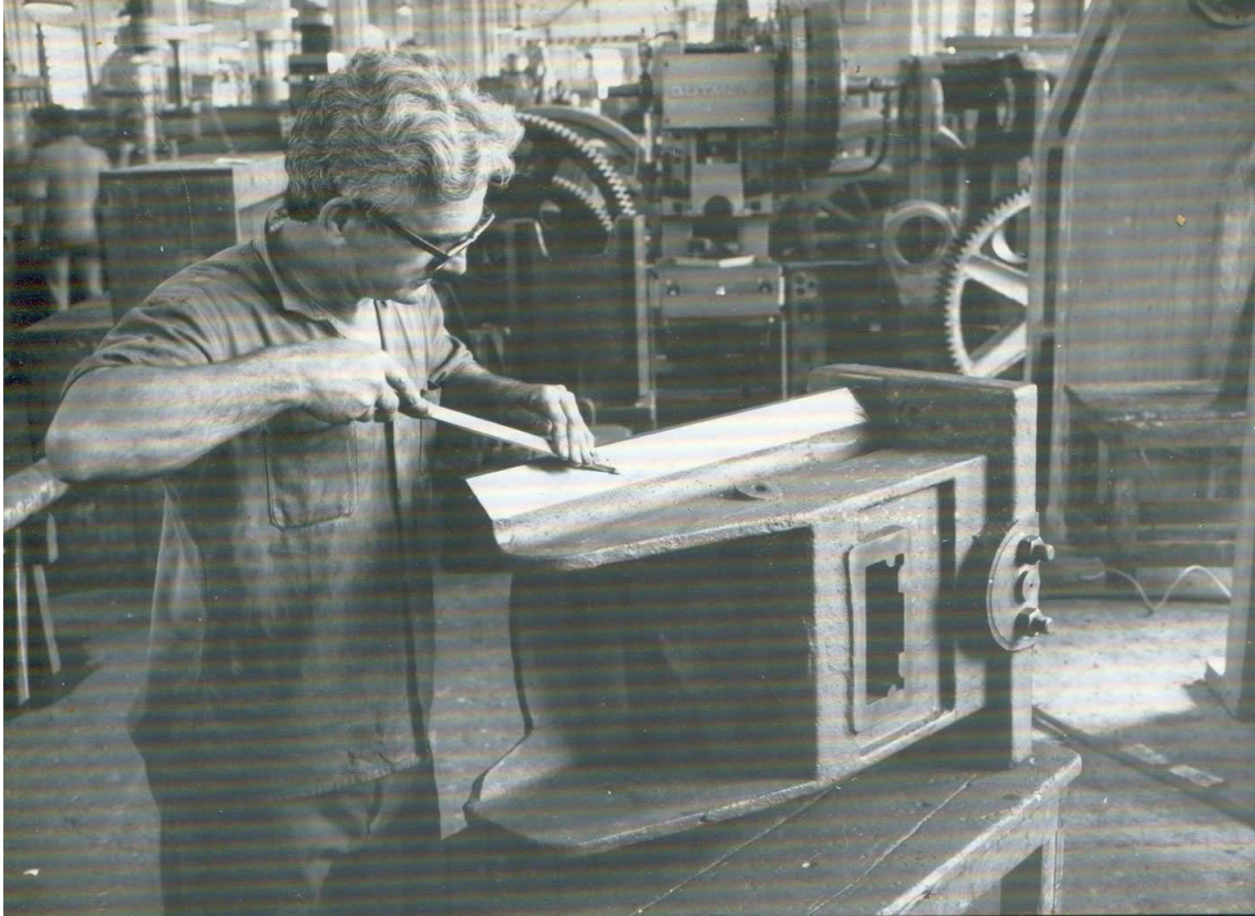
Foto 4 - Profissional rasqueteando as guias do martelo de uma prensa.
